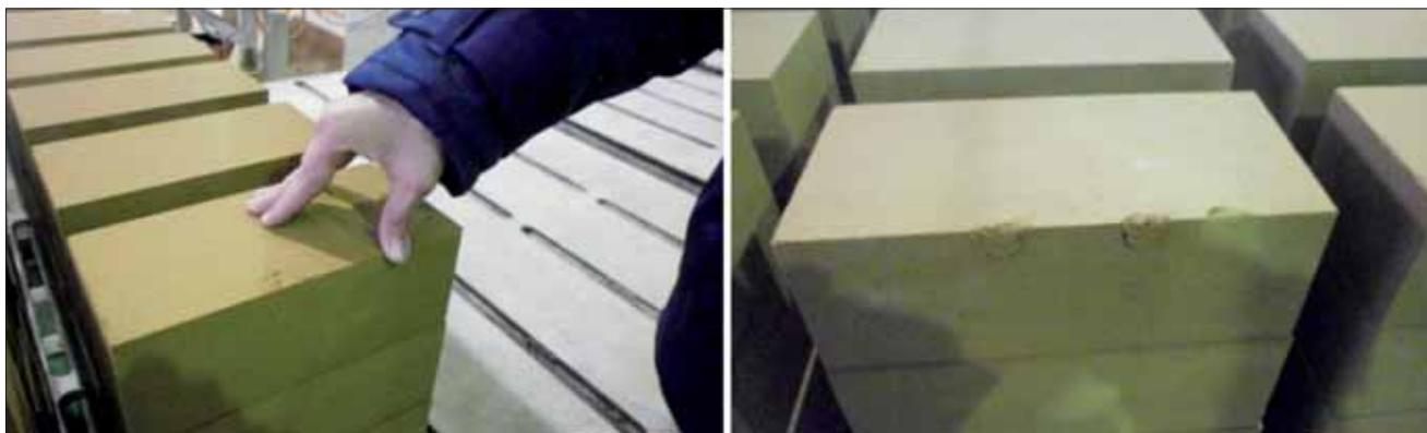
Рис. 3. Проверка прочности кирпича-сырца по смятию ребра
