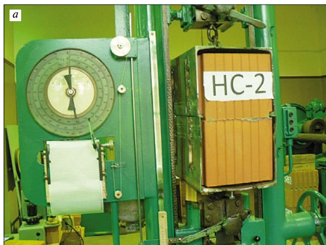
Рис. 1. Общий вид опытных образцов в прессе перед испытаниями на осевое растяжение: а – на клеевой смеси; б – на цементном растворе
