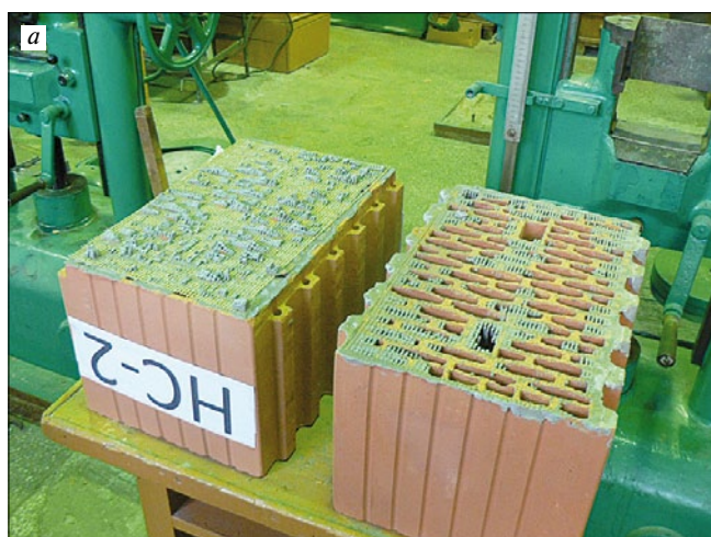
Рис. 2. Общий вид опытных образцов после испытаний: а – на клеевой смеси; б – на цементном растворе
