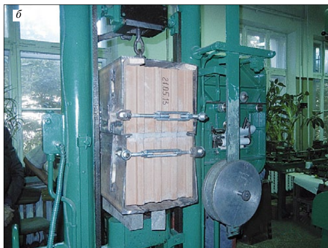
Рис. 1. Общий вид опытных образцов в прессе перед испытаниями на осевое растяжение: а – на клеевой смеси; б – на цементном растворе
