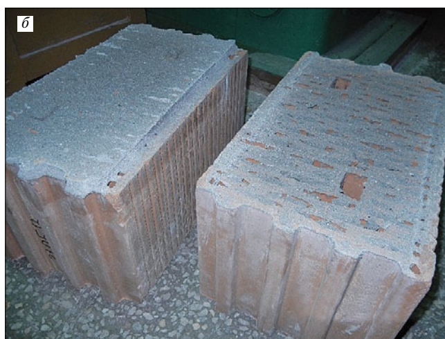
Рис. 2. Общий вид опытных образцов после испытаний: а – на клеевой смеси; б – на цементном растворе
