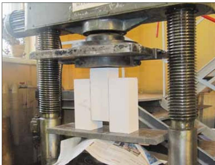
Рис. 4. Образец для испытания на срез
