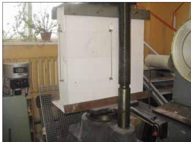
Рис. 8. Фрагмент кладки на испытательном стенде
