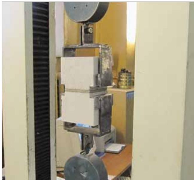
Рис. 2. Образец для испытания на адгезию
