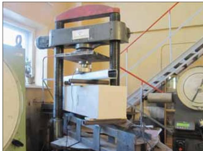
Рис. 6. Образец для испытаний на изгиб
