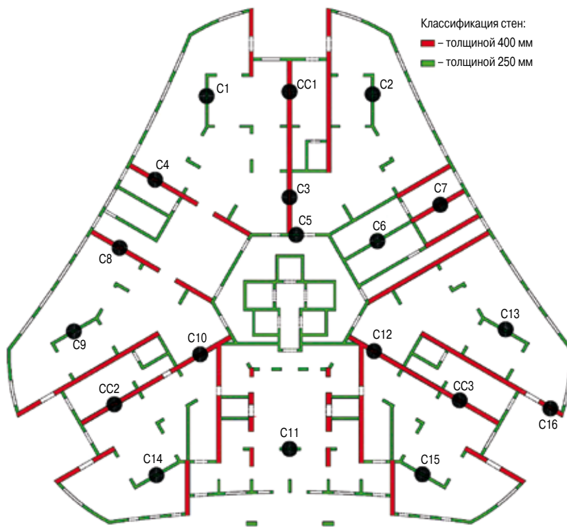
Рис. 2. Пункты измерений относительных деформаций в стенах 1-го этажа
