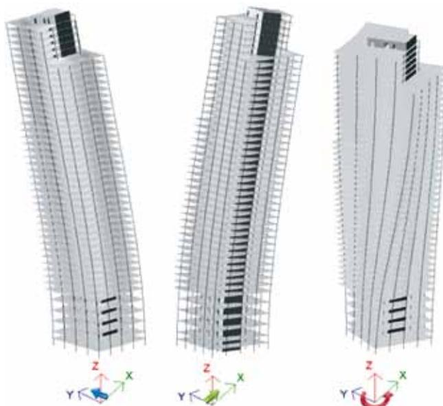
Рис. 6. Вибровоздействия от метро на проектируемое здание – низшие формы собственных колебаний эквивалентной модели здания
