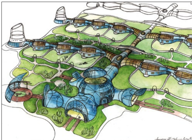
Рис. 11. Северный поселок в особо пурговом районе Крайнего Севера: жилые крылья с наветренной стороны надежно защищены грунтово-дерновыми покрытиями. Рисунок автора
