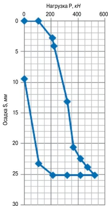
Рис. 4. Зависимость осадки оголовка сваи от нагрузки  $s=f(P)$
