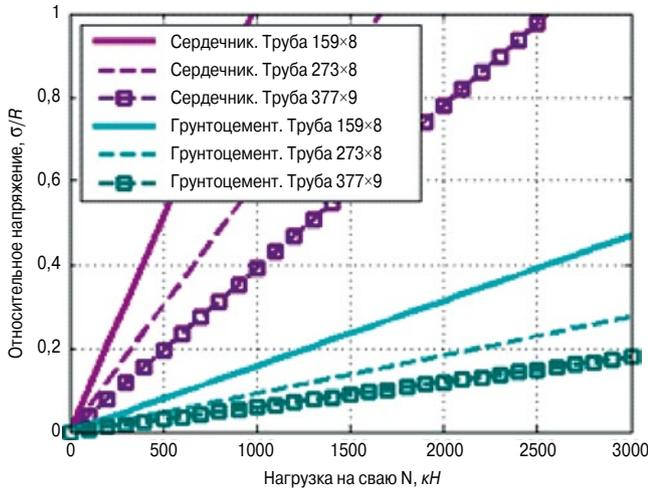
Рис. 1. Зависимость относительных напряжений в грунтоцементе и армирующей трубе от приложенной нагрузки (свая Ø600 мм, E<sub>c</sub>=200 МПа)
