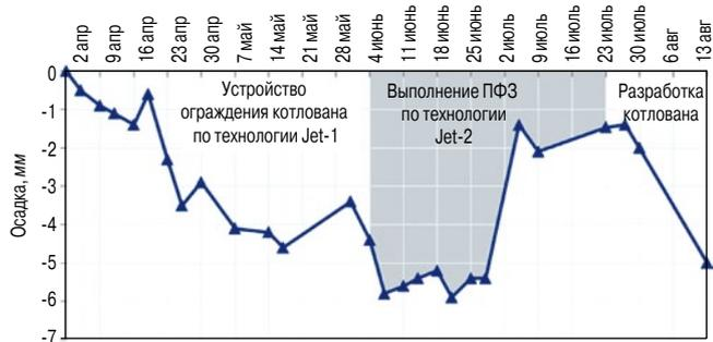
Рис. 4. График осадки репера, расположенного на внешней стене здания
