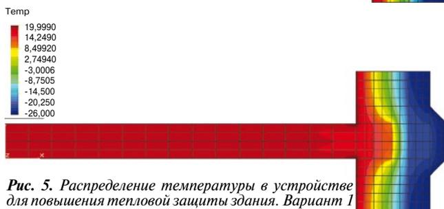
Рис. 5. Распределение температуры в устройстве для повышения тепловой защиты здания. Вариант 1
