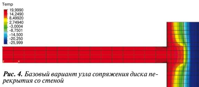
Рис. 4. Базовый вариант узла сопряжения диска перекрытия со стеной
