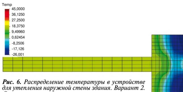
Рис. 6. Распределение температуры в устройстве для утепления наружной стены здания. Вариант 2. С утеплителем в диске перекрытия
