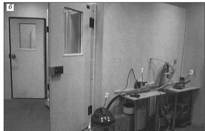
Рис. 4. Камера для теплофизических испытаний: а – внутренний вид; б – наружный вид; 1 – электросчетчик; 2 – вентилятор; 3 – микрометр; 4 – теплое отделение; 5 – холодное отделение
