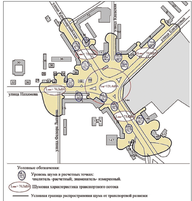
Рис. 3. Результаты измерений и расчета уровней шума в расчетных точках на территории застройки пл. Транспортной (Томск)
