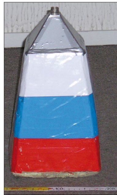
Рис. 3. Антенна для обнаружения связанной воды
