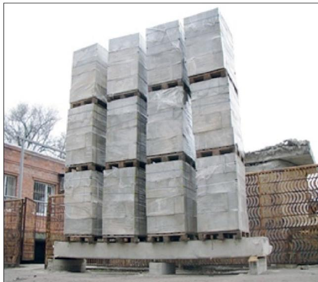
Рис. 8. Вид плиты из ФПЖБ при максимальной нагрузке
