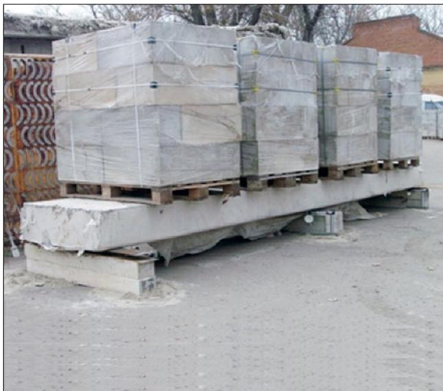
Рис. 7. Загрузка плиты из фибропеножелезобетона (ФПЖБ) при регистрации прогибов
