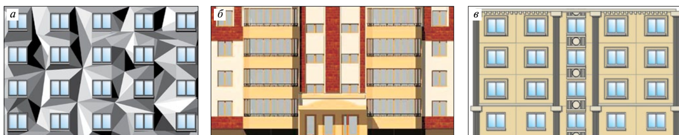
Рис. 2. Объемная графика на плоском фасаде: а – объемное изображение на основе плоских прямолинейных элементов (треугольников); б – объемное изображение на основе плоских элементов с тенями; в – объемное решение фасада с применением изображения архитектурных элементов сложной формы
