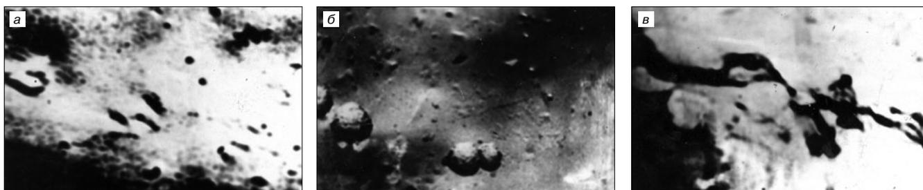
Рис. 4. Стеклофаза керамзита: а – смышляевского; б – ачинского; в – образцово-печорского
