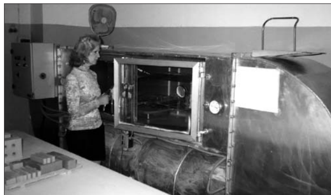
Установка для исследования процесса сушки керамических изделий
