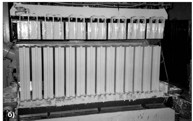
Формовочный комплекс линии по производству гипсовых перегородочных плит на Самарском гипсовом комбинате: а) общий вид формовочного комплекса; б) отформованные плиты
