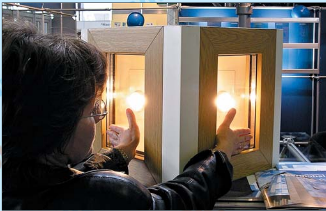
Теплоизоляционные характеристики первого в России брендированного стеклопакета Thermobel, выпускаемого с использованием низкоэмиссионного стекла Low-E, посетители могли оценить собственноручно
