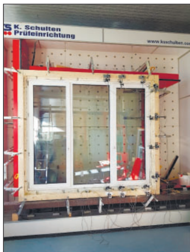
Рис. 6. Общий вид испытательного стенда с установленным оконным блоком
