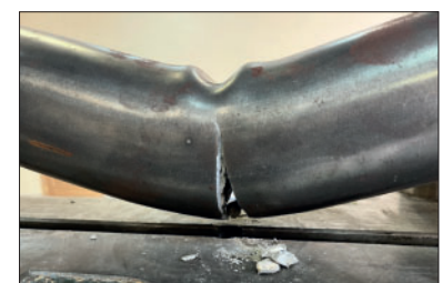
Рис. 5. Разрушение трубобетонной балки по нормальному сечению
