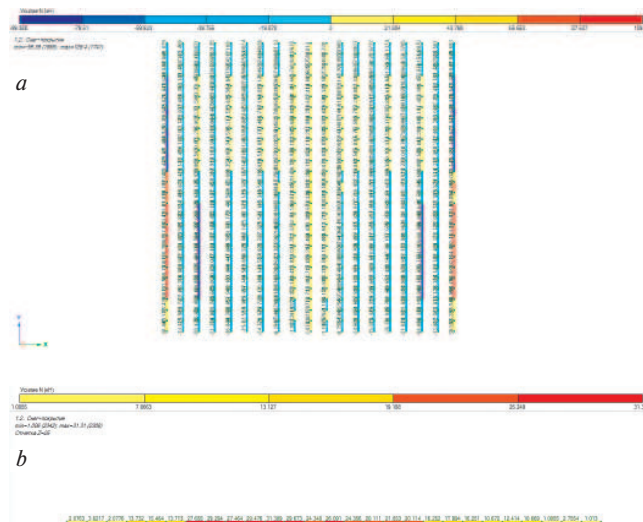
Рис. 5. Продольные усилия в прогонах при повреждении нижнего пояса и отсутствии дополнительной связевой фермы, кН: а – распределение продольных усилий в прогонах покрытия; б – продольные усилия в прогоне над поврежденной фермой Fig. 5. Longitudinal forces in the purlins in case of damage to the lower belt and the absence of an additional truss, kN: а – distribution of longitudinal forces in the purlins; б – longitudinal forces in the purlin over the damaged truss
