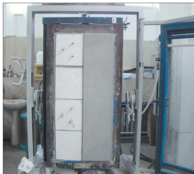
Рис. 2. Фрагменты кладки из полистиролбетона и ячеистого бетона автоклавного твердения, подготовленные для проведения испытаний методом одностороннего замораживания
