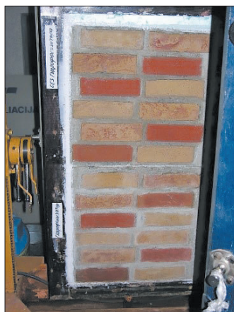
Рис. 1. Холодильно-дождевальная установка ХДУ-0.2 «Термоизоляция» с возможностью охлаждения до -30°C, системой орошения, обогрева, ИК- и УФ-облучения
