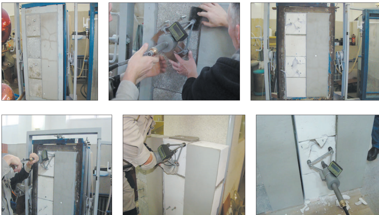
Рис. 3. По завершении циклических воздействий, через 150 циклов, проведены испытания прочности на вырыв химических анкеров и прочности сцепления (адгезии) полистиролбетонных и ячеисто-бетонных блоков со штукатурным раствором, с кладочным раствором и с клеевой композицией
