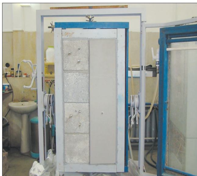
Рис. 2. Фрагменты кладки из полистиролбетона и ячеистого бетона автоклавного твердения, подготовленные для проведения испытаний методом одностороннего замораживания
