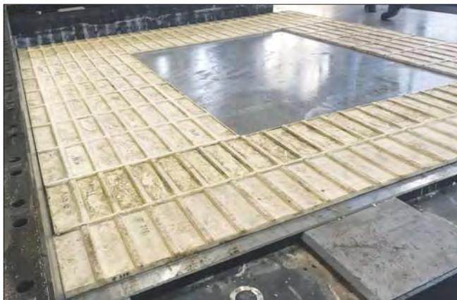
Рис. 4. Матрица для крепления клинкерной плитки
