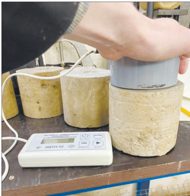
Рис. 2. Измерение теплопроводности образца с помощью прибора ИВТП-12
