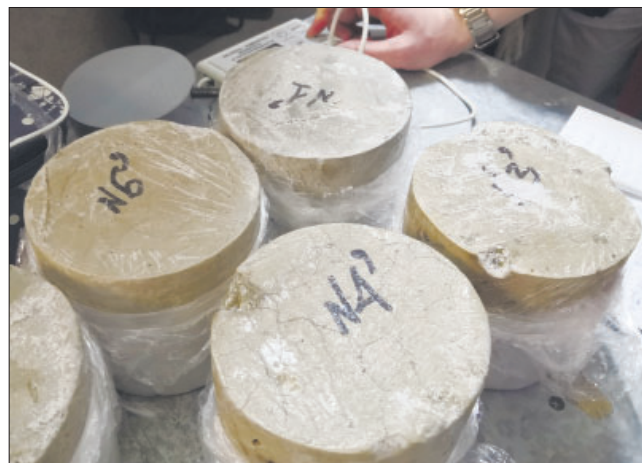
Рис. 3. Образцы грунтоцемента в мерзлом состоянии Fig. 3. Cemented soil samples in a frozen state
