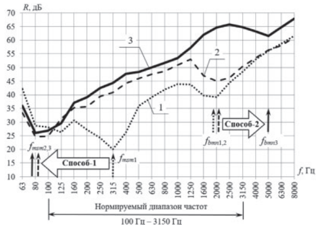
Рис. 4. Экспериментальные частотные характеристики звукоизоляции легких бескаркасных перегородок с акустическим разобщением слоев и фрагментированными торкрет-облицовками (размеры образцов 2 \times 1,2 м; монолитные торкрет-облицовки из гипсовой смеси h_1=24 мм; средний слой из жесткой минеральной ваты, h_2=50 мм; акустическое разобщение из матов полиэфирного волокна, h_3=4 мм): 1 – исходный образец (без акустического разобщения слоев и без фрагментирования торкрет-облицовок), общая толщина образца h_{en}=98 мм; 2 – образец с акустическим разобщением слоев (реализация «Способа-1»), общая толщина образца h_{en}=106 мм; 3 – образец с акустическим разобщением слоев и фрагментированными торкрет-облицовками (совместная реализация «Способа-1» и «Способа-2»), общая толщина образца h_{en}=106 мм
