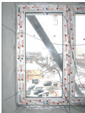
Рис. 1. Испытуемый оконный блок с измерительным оборудованием Fig. 1. Tested window block with measuring equipment
