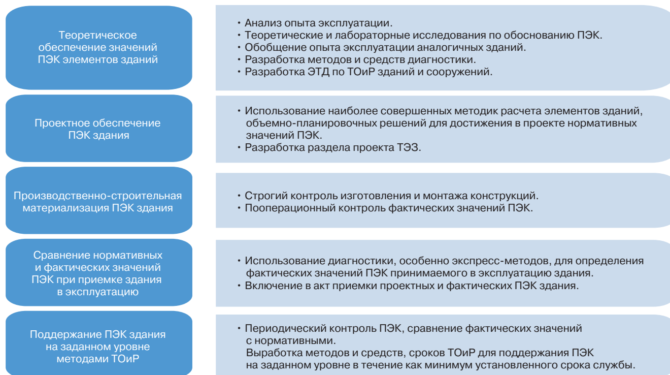
Рис. 3. Методы обеспечения эксплуатационных качеств в различных этапах жизненного цикла здания
