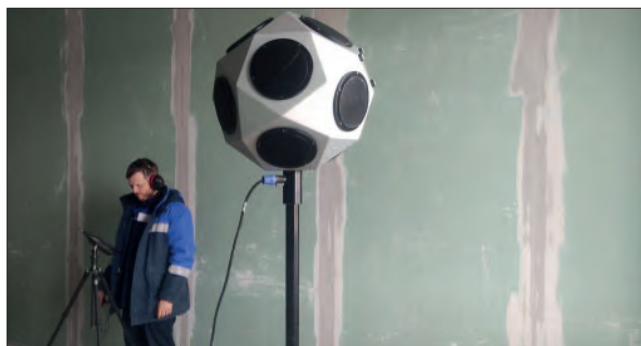
Рис. 2. Перегородка из пазогребневых блоков, обшитая с одной стороны листами гипсокартона Fig. 2. Partition of tongue-and-groove blocks, sheathed on one side with sheets of drywall
