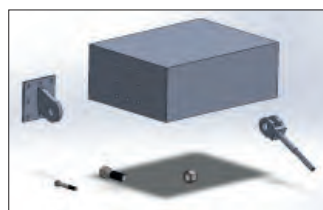
Рис. 6. Моделирование узла крепления вант к железобетонному пилону
