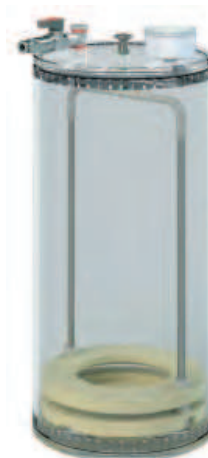
Рис. 4. Общий вид вакуумной камеры водонасыщения
