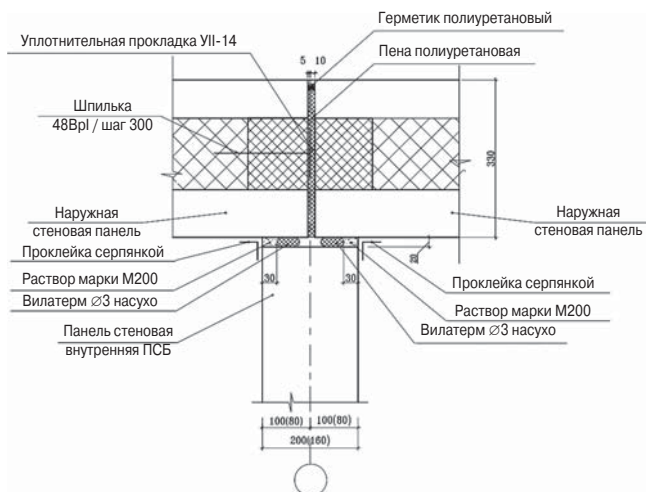
Рис. 1. Современное решение соединений панелей наружных стен Fig. 1. Modern solution of external wall panel connections
