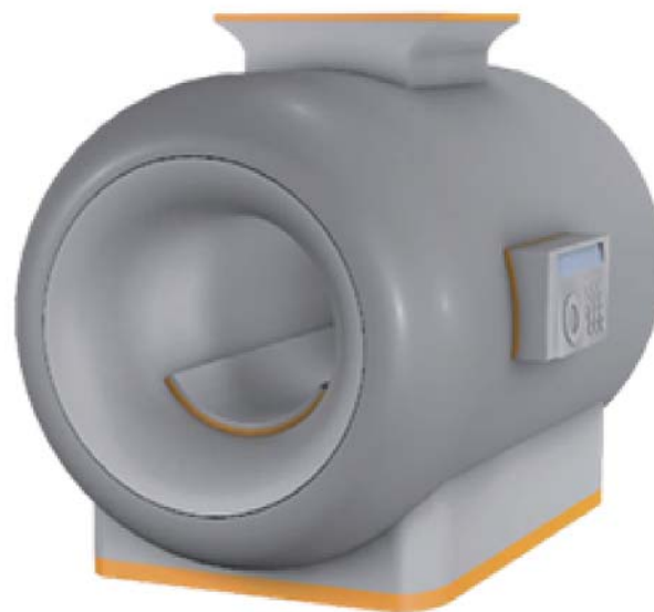
Рис. 4. Схема виброизоляции томографа (схематично показана темно-желтым цветом)
