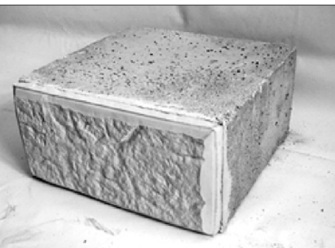
Рис. 1. Полистиролбетонный блок с облицовочным слоем
