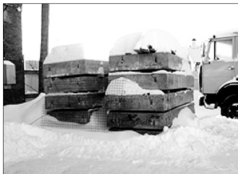
Рис. 2. Стеновые панели из полистиролбетона
