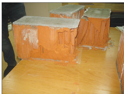
Рис. 2. Образцы керамических камней после испытания на сжатие
