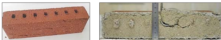
Рис. 3. Проверка надежности анкеровки связей из стальных стержней в кладку лицевого слоя толщиной 65 мм [10]
