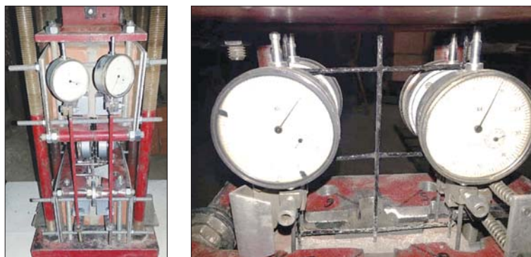
Рис. 1. Испытания гибких связей из стеклокомпозитных сеток на вырыв из растворяющих швов кладки [1, 3] Fig. 1. Testing of flexible ties made of glass-composite meshes for breaking out of mortar joints of masonry [1, 3]
