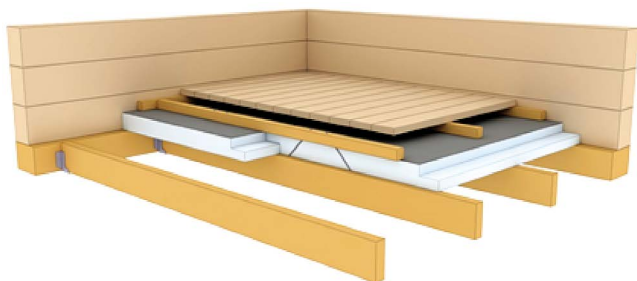
Рис. 1. Пол по лагам с фиксацией наклонными саморезами
