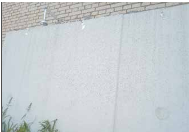
Рис. 2. Исследуемая стена с датчиками температуры на фасаде № 1, 2, 3 и на выносе под козырьком Fig. 2. The wall under study with temperature sensors on the facade #1, # 2, # 3 and on the carry-out under the canopy
