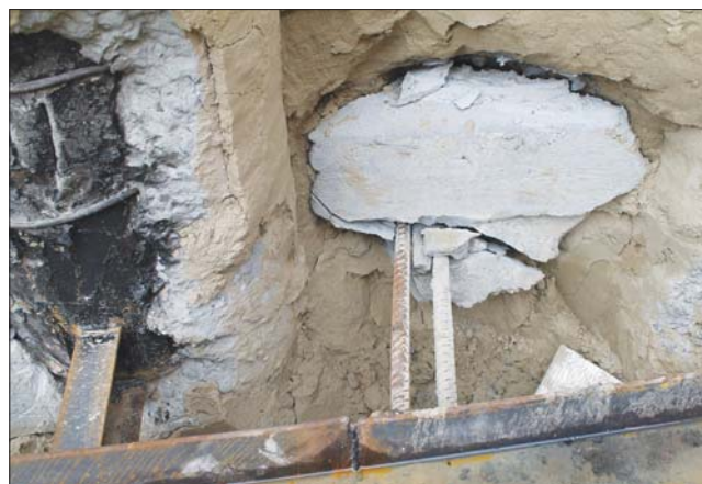
Рис. 16. Выход анкерной сваи-РИТ на 4 см при усилии натяжения 100 кН
