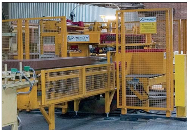
Рис. 2. Многострунное разрезное устройство MULTICUT
