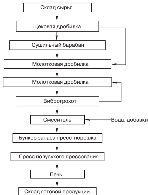
Технологическая схема производства керамического кирпича на основе опоковидных пород
