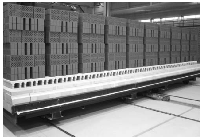
Туннельная вагонетка фирмы Буртон, туннельная печь фирмы Келлер, Завод ОАО Лесома - Тула 3 (Тула). Поставлено 55 туннельных вагонеток (в эксплуатации с 2008 года)
