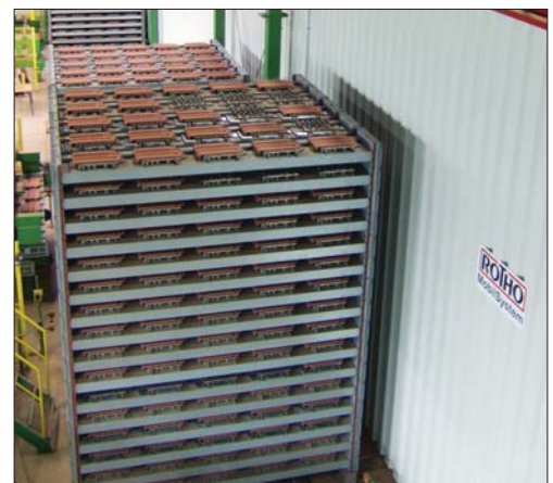
Рис. 7. Базовый модуль скоростной сушки черепицы
