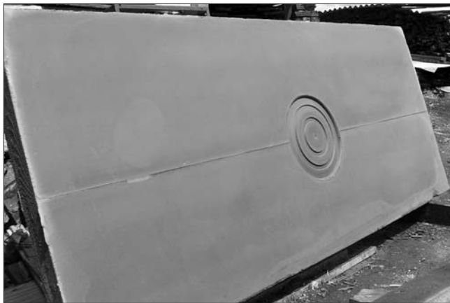
Рис. 3. Пробный образец крупноразмерного декоративного железобетонного экрана
