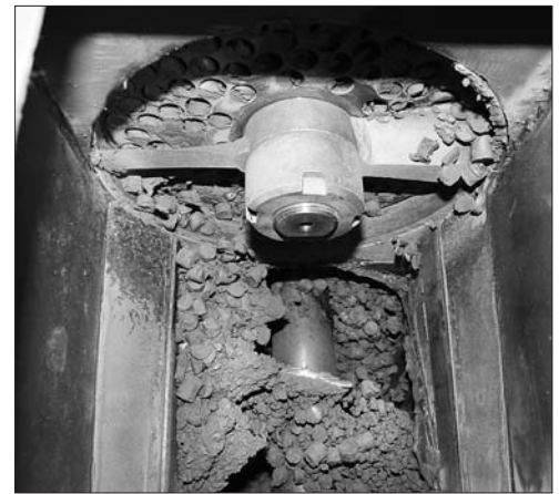
Рис. 3. Выход гранул из установки «Каскад-гран-4»
