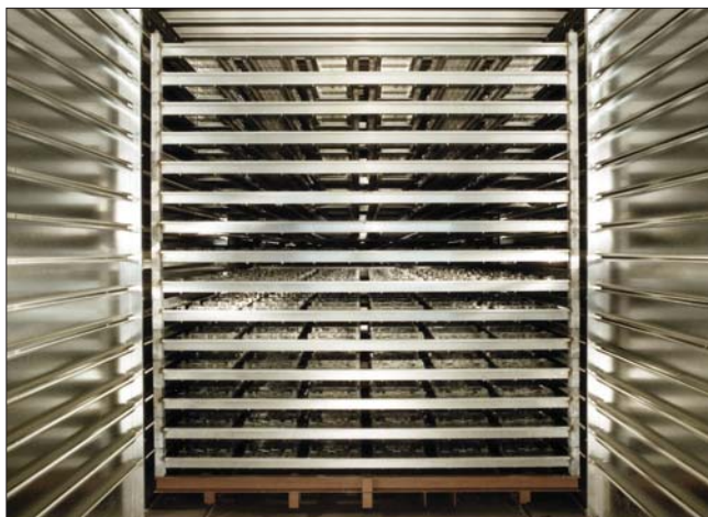
Рис. 13. Сушилка с шлицевыми стенками для черепицы
