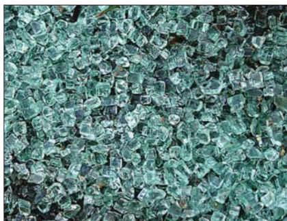
Рис. 3. Пример разрушения закаленного стекла
