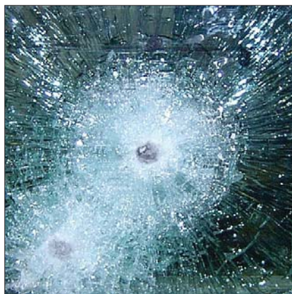
Рис. 1. Пример разрушения ламинированного стекла
