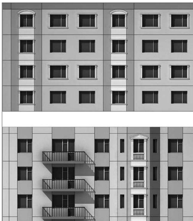
Рис. 1. Архитектурные решения фасада здания с применением декоративных железобетонных экранов
