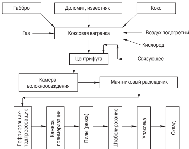
Рис. 1. Схема производства теплоизоляционных плит из базальтовой ваты с синтетическим связующим
