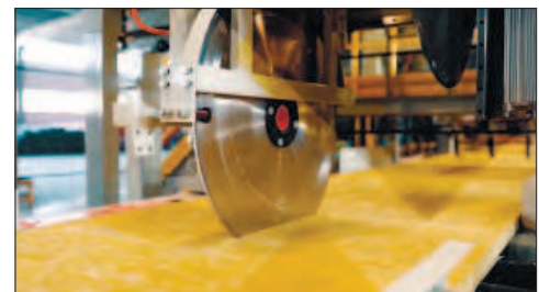
Рис. 7. Резка минераловатного ковра на плиты Fig. 7. Cutting of mineral wool carpet into slabs
