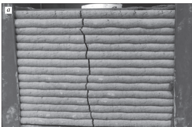
Рис. 18. Характер разрушения прямоугольного элемента несъемной опалубки с высотой печатного слоя 2 см: без холодного шва (а) и с холодным швом (b)
