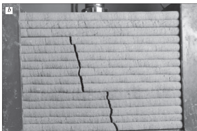
Рис. 18. Характер разрушения прямоугольного элемента несъемной опалубки с высотой печатного слоя 2 см: без холодного шва (а) и с холодным швом (b)
