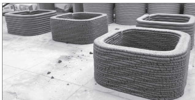
Рис. 5. Изделия в форме колодцев с высотой печатного слоя 1 см (2 шт.) и высотой печатного слоя 2 см (2 шт.), изготовленные для выпиливания образцов 160×40×40 мм
