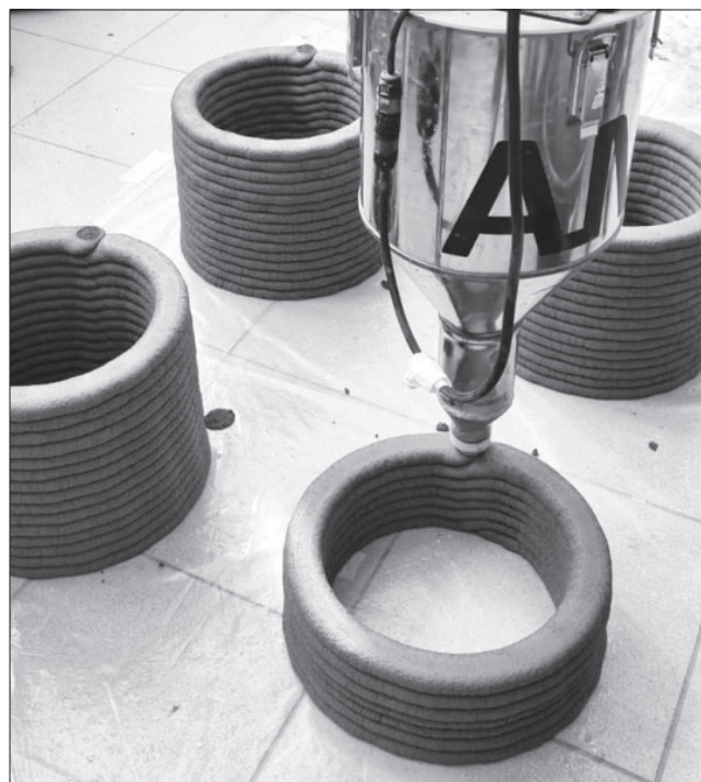
Рис. 8. Процесс изготовления серии из четырех образцов опалубки замкнутой цилиндрической формы
