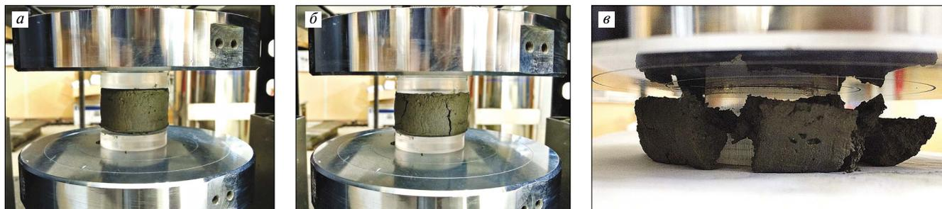
Рис. 2. Образец цементного теста в процессе испытания на сдавливание: а – начало испытания; б – начало разрушения; в – окончание испытания
