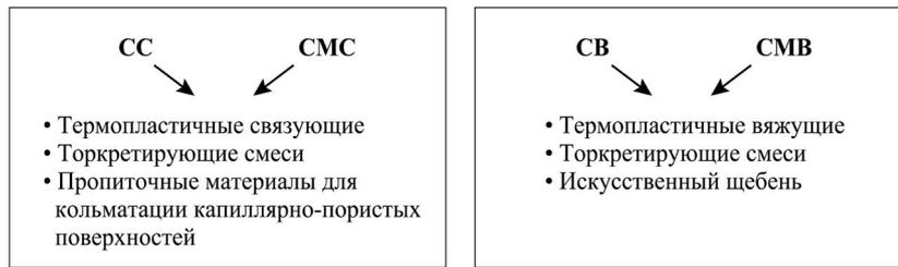
Рис. 4. Области применения серных композитов разных структурных уровней
