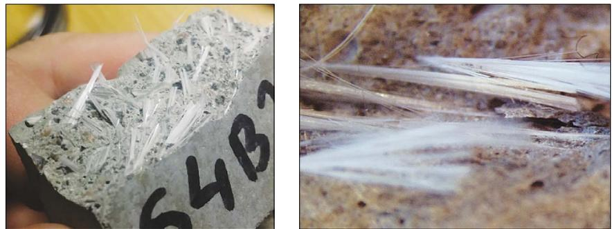
**Рис. 10.** Стекловолокна в поперечной трещине со случайным их распределением
