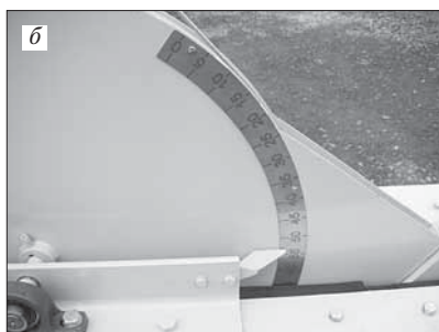
Рис. 4. Установка для испытания на удар (Wi-Tester): а – рабочая зона; б – шкала измерения угла падения
