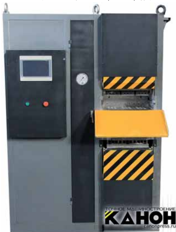
Рис. 1. Пресс А300-3М. Производительность 900 шт./ч; усилие прессования 300 т; тип прессования – двухстороннее, встречное; максимальный размер изделия 382×250×88 мм
