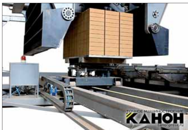
Рис. 2. Манипулятор-пакетировщик МПК-6. Максимальный вес переносимого груза 2 т; усилие сжатия 6 т; максимальный размер переносимой стопки 1038×768×950 мм
