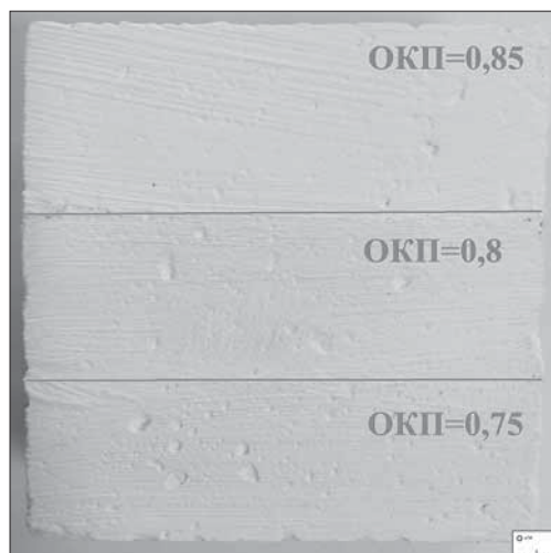
Рис. 4. Характер покрытия краской на основе акриловой дисперсии, нанесенного на вертикальную поверхность композиции цементно-известковый камень – грунтовка
