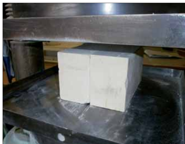
Рис. 4. Испытание кирпича-сырца, спрессованного на ребро в положении прессования
