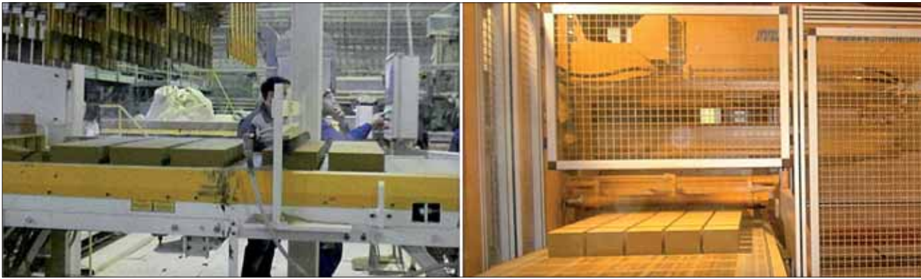
Рис. 1. Прессование кирпича на постель
