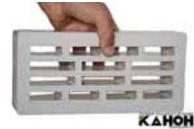
Рис. 4. Карбонатный кирпич. Марка 200; пустотность 40%; водопоглощение 7,5%; морозостойкость более 100
