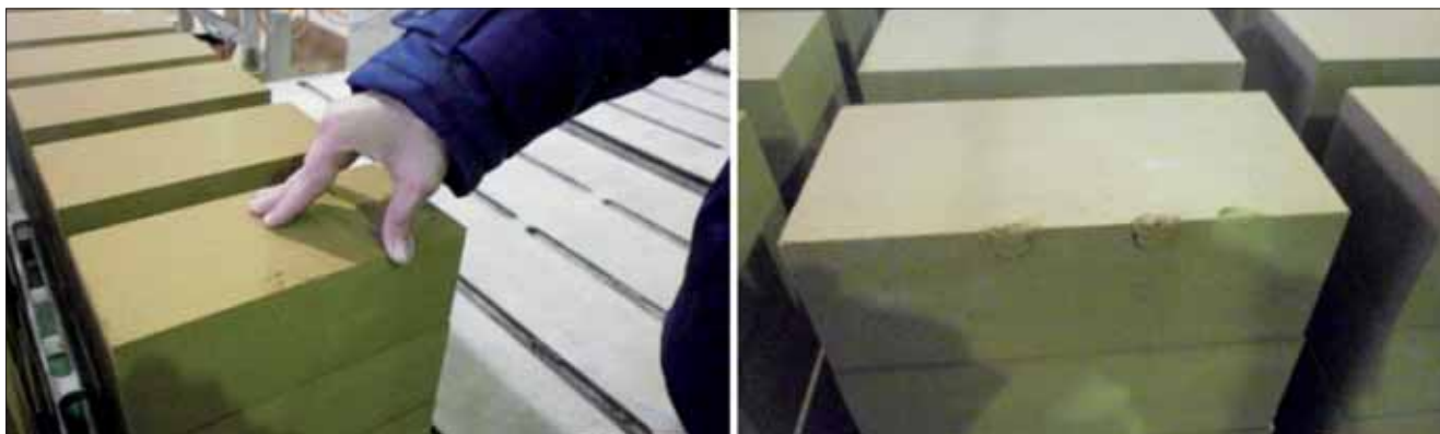
Рис. 3. Проверка прочности кирпича-сырца по смятию ребра
