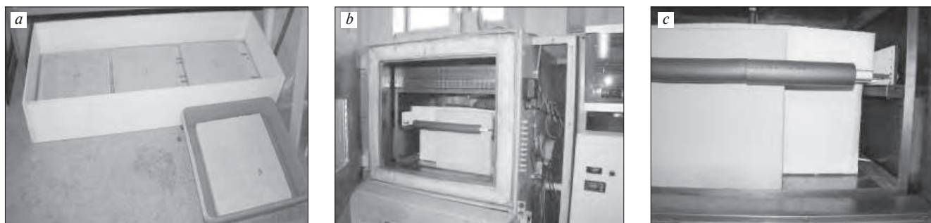
Рис. 2. Подготовка (а) и проведение испытания фрагментов в климатической камере термоудара TSK300 (b, c)
