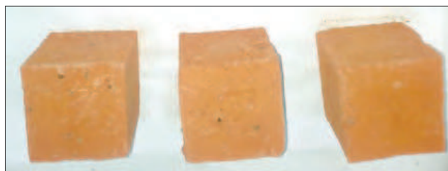
Рис. 1. Обожженные керамические пористые образцы на основе пеностекла и суглинка Fig. 1. Fired porous ceramic sample cubes based on foam glass and loam
