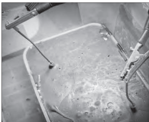
Рис. 1. Измерение сопротивления образца Fig. 1. Sample resistance measurement
