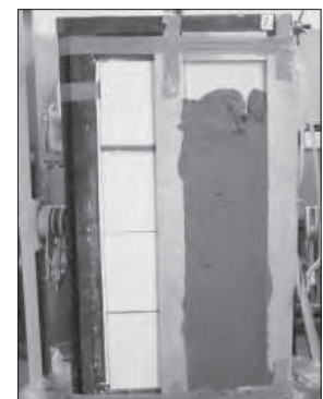
Рис. 2. При устройстве кладки в стену устанавливали датчики температуры (термохроны). Правая половина фрагмента была оштукатурена, левая – не оштукатурена. Одновременно с основными фрагментами были подготовлены контрольные фрагменты кладок
