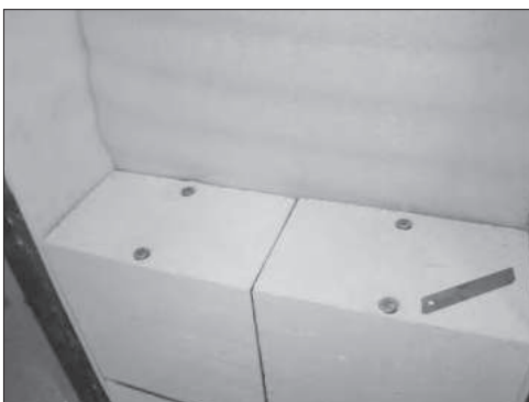
Рис. 2. При устройстве кладки в стену устанавливали датчики температуры (термохроны). Правая половина фрагмента была оштукатурена, левая – не оштукатурена. Одновременно с основными фрагментами были подготовлены контрольные фрагменты кладок
