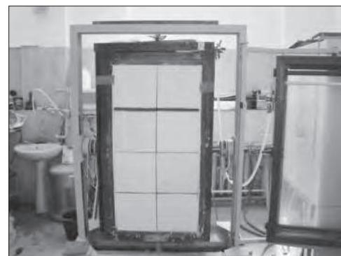
Рис. 2. При устройстве кладки в стену устанавливали датчики температуры (термохроны). Правая половина фрагмента была оштукатурена, левая – не оштукатурена. Одновременно с основными фрагментами были подготовлены контрольные фрагменты кладок
