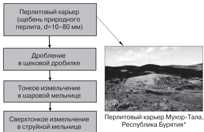
Рис. 1. Технологическая схема получения тонкодисперсного перлита. *Фото взято из открытого источника информации
