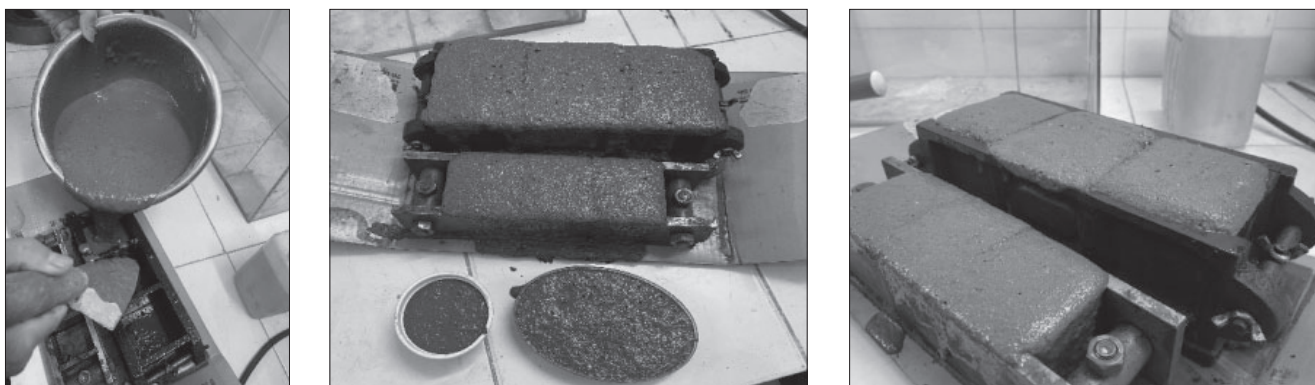
Рис. 5. Изготовление газобетонных образцов Fig. 5. Production of aerated concrete samples
