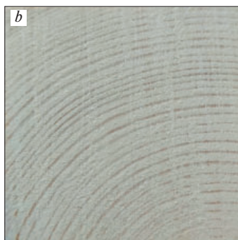
Рис. 3. Спили образца с распилом: a – вдоль волокон; b – поперек волокон
