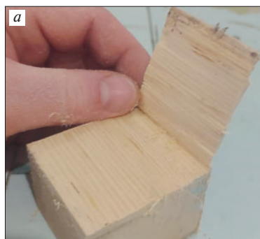
Рис. 3. Спили образца с распилом: a – вдоль волокон; b – поперек волокон
