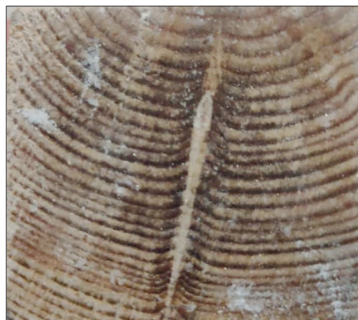
Рис. 2. Вид торцевой части соснового бруска после обработки в автоклаве
