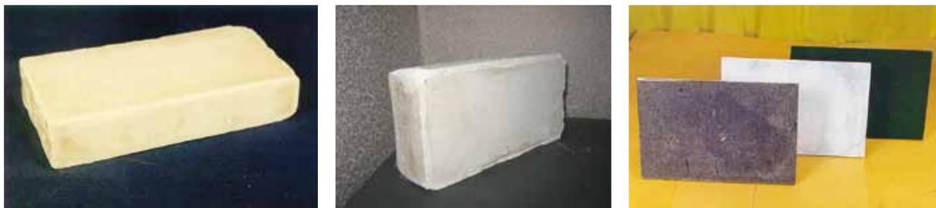
Рис. 4. Опытные образцы кирпича и облицовочной плитки из бесклнкерного композита контактно-конденсационного твердения с портландитовой матрицей
