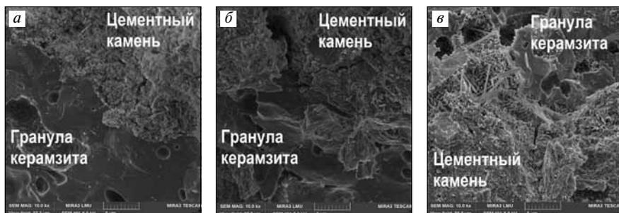
**Рис. 1.** Микроструктура крупнопористого керамзитобетона: а – контрольный образец (×10000); б – с керамзитом, модифицированным наночастицами метакаолина со стабилизатором С-3 (×10000); в – с керамзитом, модифицированным наночастицами метакаолина со стабилизатором ПВС (×10000)
