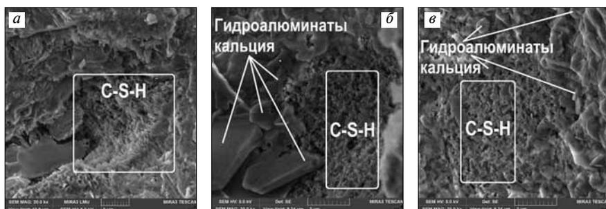
**Рис. 2.** Микроструктура цементного камня в контактной зоне с керамзитом в крупнопористом керамзитобетоне: а – контрольный образец (×20000); б – с керамзитом, модифицированным наночастицами метакаолина со стабилизатором С-3 (×30000); в – с керамзитом, модифицированным наночастицами метакаолина со стабилизатором ПВС (×30000)
