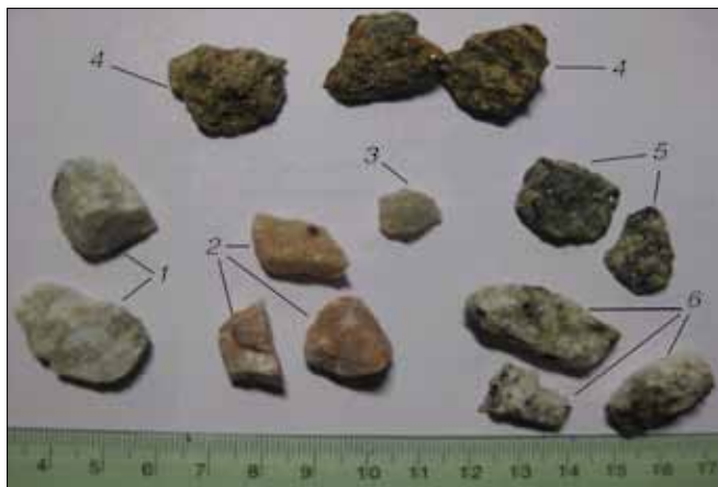
Рис. 7. Зерна щебня фракции 10–20 мм из гранита (материал одной пробы): 1 – зерна плагиоклаза; 2 – зерна микроклина; 3 – зерно кварца; 4 – зерна со следами выветривания; 5 – зерна, содержащие плагиоклаз, амфибол и биотит в сростании; 6 – зерна, содержащие плагиоклаз и амфибол в сростании
