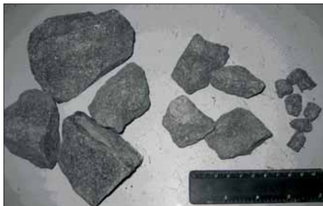
Рис. 5. Зерна щебня из габбро-диабазы
