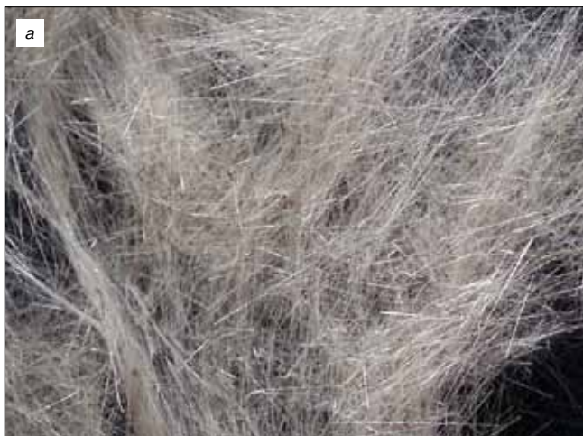
Рис. 2. Микрофотографии минеральных волокон (х 300): а – золотшлаковые отходы d=9 мкм; б – продукты сжигания сланцев, d=11 мкм
