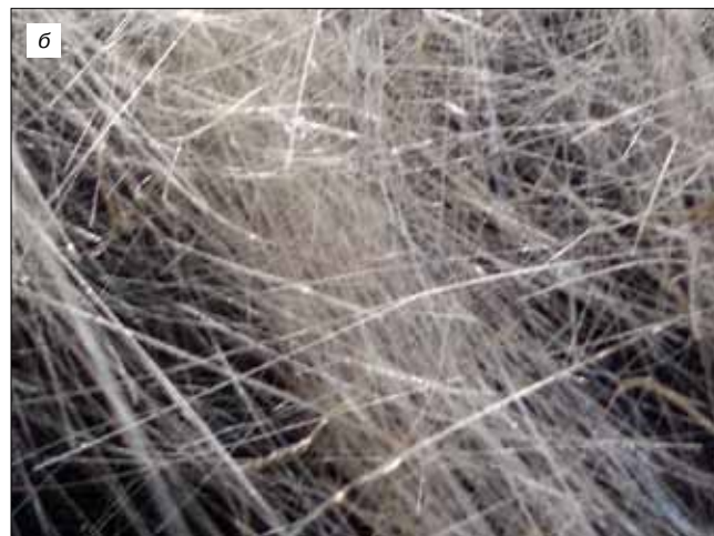
Рис. 2. Микрофотографии минеральных волокон (х 300): а – золотшлаковые отходы d=9 мкм; б – продукты сжигания сланцев, d=11 мкм
