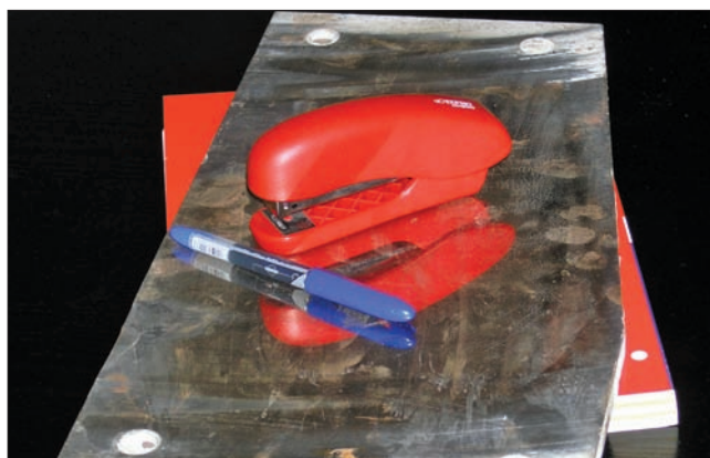
Износостойкие пластины «ВИЗО» после воздействия силикатной массы
