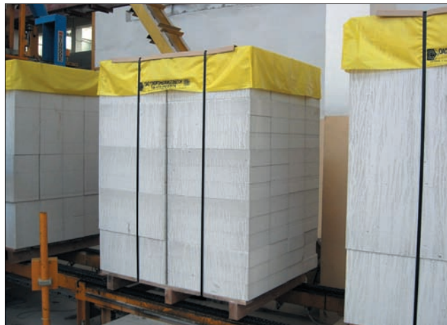
Поддон с упаковкой газобетонных блоков
