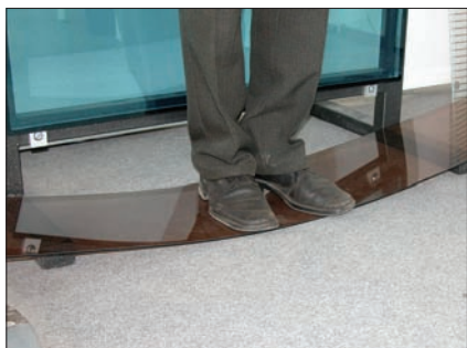
В результате термообработки стекла ООО «Уральская стекольная компания» получает материал, который гнется, но не ломается
