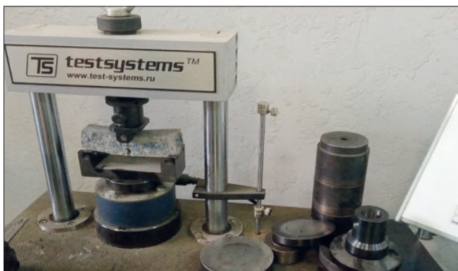
Рис. 3. Испытание образцов-балочек на изгиб Fig. 3. Bending test of beam samples
