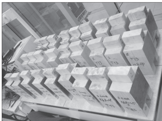
Рис. 3. Общий вид образцов соединения КМ-обклейка тип 1, 2 и 3 с обклейкой в 2, 4 и 6 слоев Fig. 3. General view of samples of CM-gluing connections types 1, 2 and 3 with gluing in 2, 4 and 6 layers
