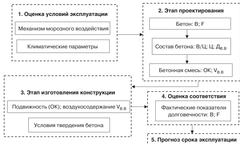
Рис. 1. Принципиальная схема этапов формирования показателей долговечности бетона для агрессивной среды класса XF4
