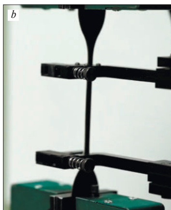
Рис. 2. Мембрана LOGICBASE™ V-SL (а); испытание образца мембраны LOGICBASE™ V-SL на осевое растяжение (б)
