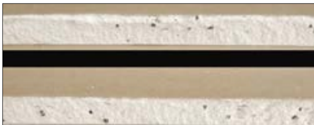
Рис. 5. Структура сердечника плиты гипсовой радонозащитной (ПГР)
