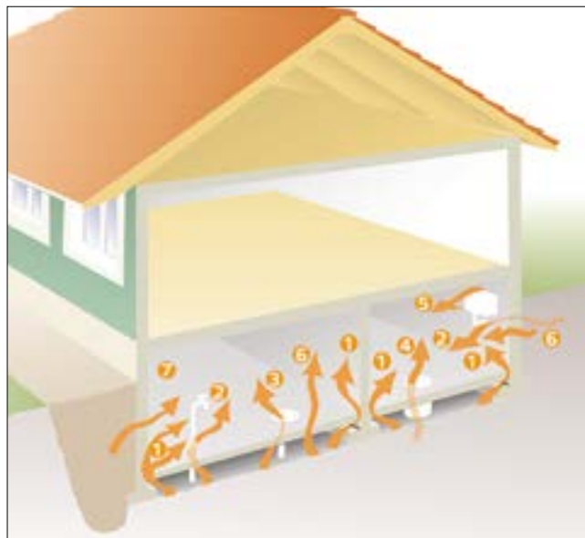
Рис. 6. Места проникновения радона в подвальное помещение [11]: 1 – между плитами пола и стеной; 2 – негерметичные участки трубопровода и канализации; 3 – негерметичные участки скважин; 4 – негерметичные участки канализации; 5 – негерметичные участки проложенной телефонной проводки; 6 – трещины при осадке здания; 7 – из строительных воздухопроницаемых материалов, таких как керамзит, полые блоки, швы и т. д.
