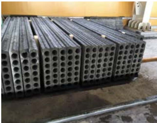
Готовые стеновые панели толщиной 90 мм
