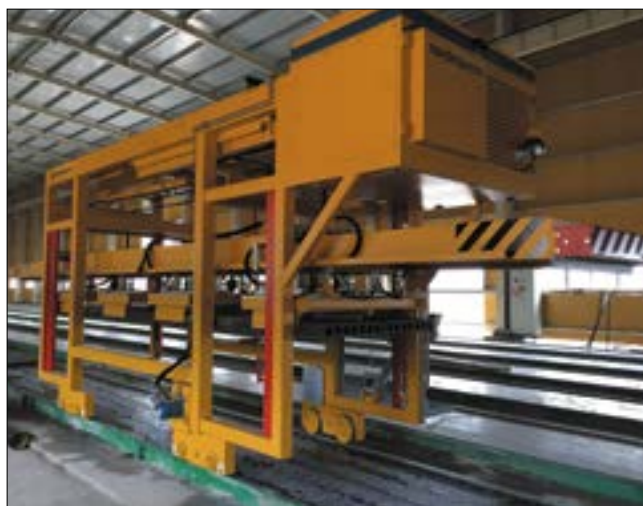
Специализированная машина для подъема пустотной стеновой панели
