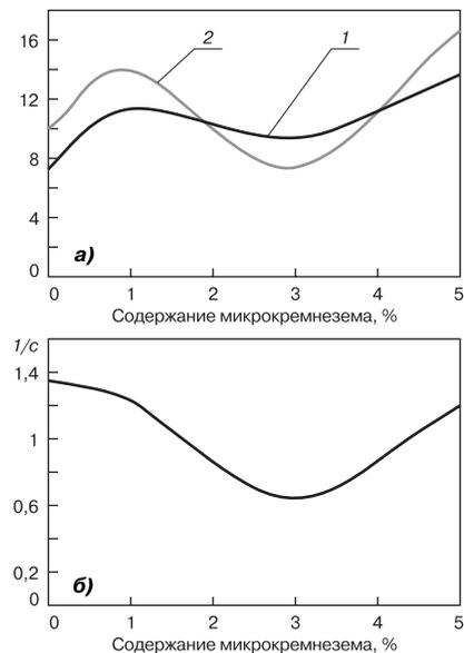
**Рис. 2.** Зависимость вязкости и предельного напряжения сдвига (а) и пластичности по Воляровичу (б) от содержания микрокремнезема: 1 – пластическая вязкость (Па·с); 2 – предельное напряжение сдвига (Па)
