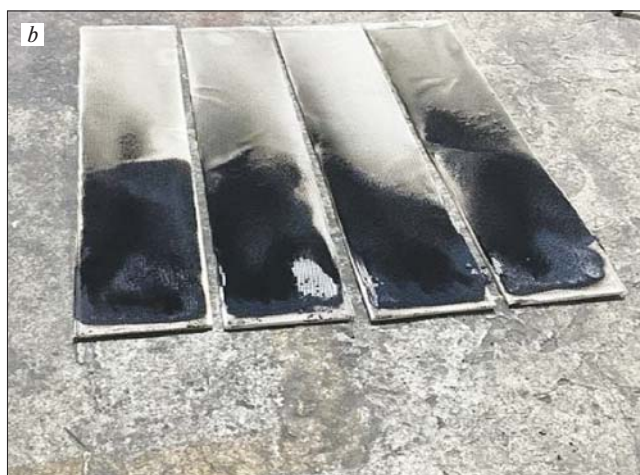
Рис. 2. Огнезащитная сетка на конструкциях ферм (а) и образцы сетки после испытания на горючесть (b) Fig. 2. Fire retardant mesh on truss structures (a) and mesh samples after the flammability test (b)
