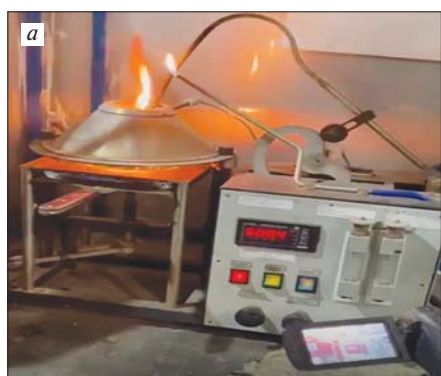
Рис. 3. Испытания на воспламеняемость (а); образец после испытания (b) Fig. 3. Flammability tests (a); Sample after test (b)
