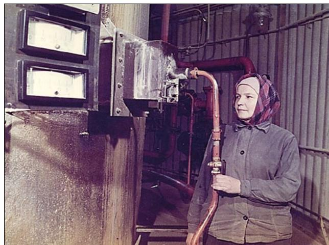
Рис. 1. Вид периферийной горелки типа ГФИ, установленной в зоне обжига печи, при ее обслуживании обжигальщиком
