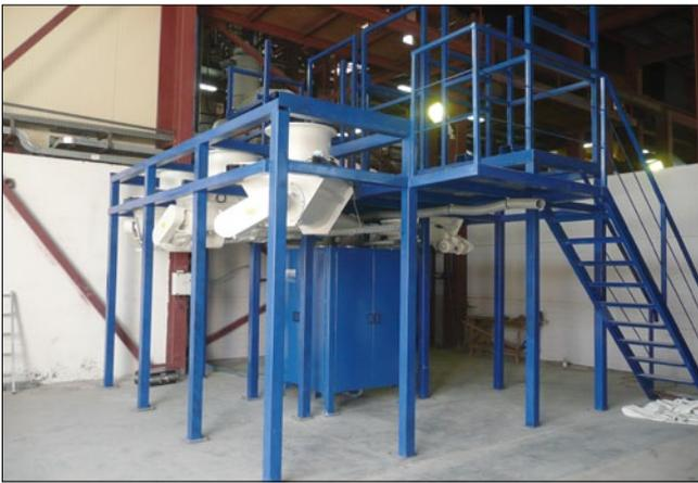
Рис. 3. Дозатор порошковых пигментов типа FLEX 100-1 для пяти цветов, установленный на Борском силикатном заводе
