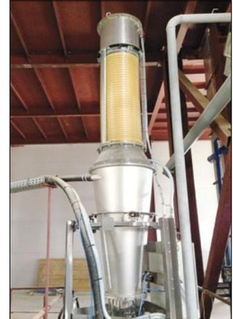
Рис. 6. Фильтр-циклон над смесителем для хранения порции пигмента
