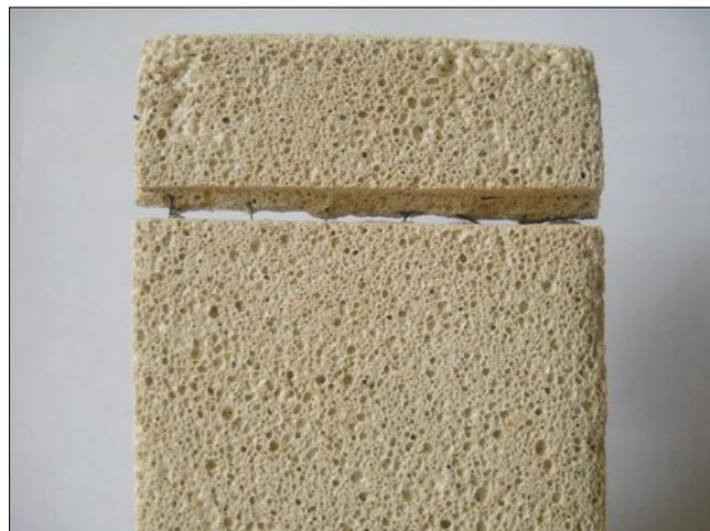
**Рис. 2.** Пеностекло, армированное металлической сеткой. Две части пеностекла по распилу держатся за счет армирующей сетки
