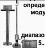
определение динамического модуля упругости грунтов и оснований дорог методом штампа, диапазон: 5...370 МН/м<sup>2</sup> ("Удар")
