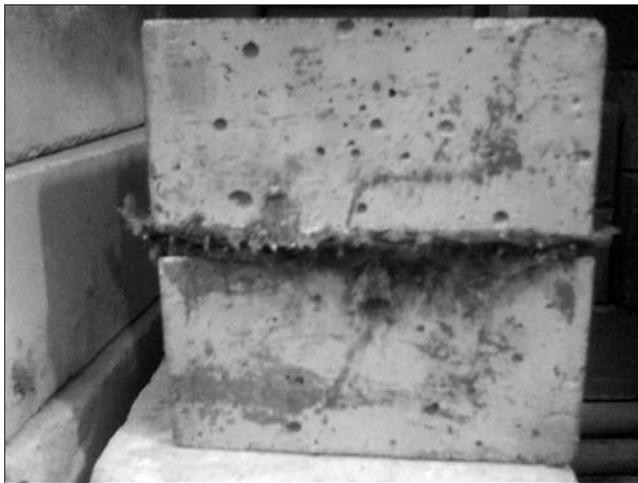
Рис. 2. Вид образцов с армодемпфером
