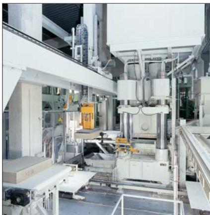
Пресс DORSA 2000 с двумя линиями резки для производства фигурных элементов. После прессования автоматическое приемное устройство снимает силикатный элемент и переставляет его на транспортер подачи к линии резки, чтобы на выходе получить желаемую конфигурацию элемента. В зависимости от производительности установки пресс DORSA 2000 может быть оснащен одной или двумя линиями резки
