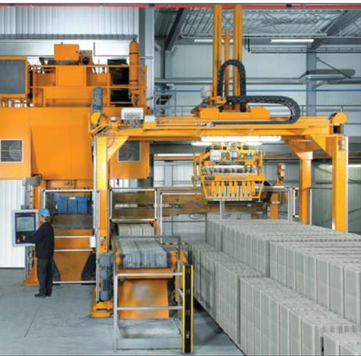
Пресс HDP 800 Jumbo при производстве силикатных изделий размерами 250×250×248 мм
