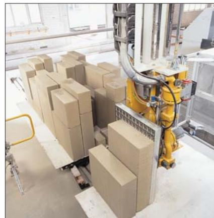
Автомат-компоновщик после линий резки устанавливает фигурные элементы на запарочную тележку. Посредством сегментно-управляемой вакуумной пластины грейфера возможна аккуратная компоновка изделий различных видов на запарочной тележке
