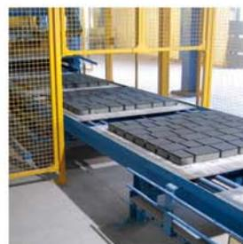
Установки для производства мелкокоразмерных бетонных элементов
