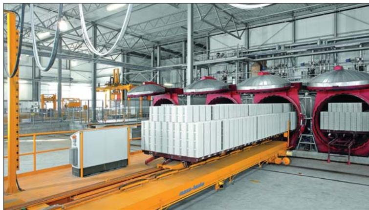
Трансбордер в зоне автоклавов емкостью до восьми запарочных тележек применяется для загрузки и разгрузки автоклавов. При данной концепции возможно использование тупиковых автоклавов, благодаря чему внутренний транспорт осуществляется в пределах одного цеха. Это особенно важно при зимнем производстве в холодных регионах страны
