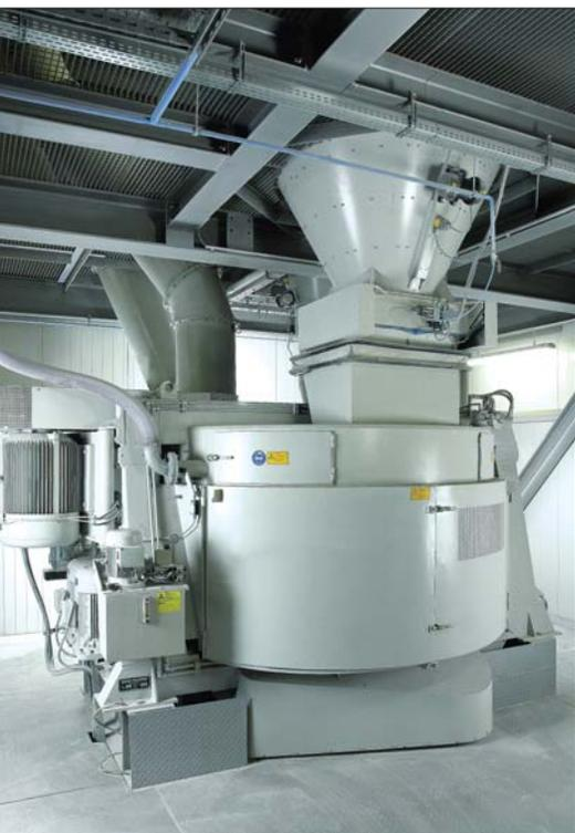
В смесителе интенсивного действия сырьевые материалы перерабатываются до состояния однородной массы. После завершения процесса перемешивания масса поступает в реакторы, расположенные над прессами, где происходит реакция гашения извести
