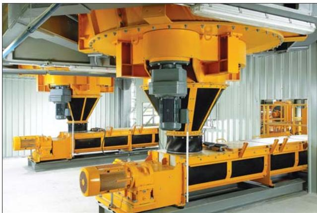
Для получения однородной силикатной массы наряду со смесителем интенсивного действия особенно важно наличие второй смесительной установки после реактора. В данной установке последующего смешивания происходит окончательное увлажнение силикатной массы непосредственно перед подачей в пресс, а также завершается процесс гашения извести. Установка последующего смешивания состоит из устройства разгрузки реактора с целевой подачей материала в двухвальную смеситель
