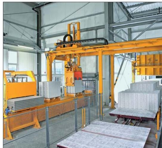
Под грейфером разгрузки происходит автоматическое позиционирование запарочной тележки
