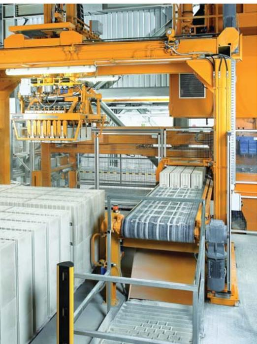
Загрузка запорочных тележек автоматом-укладчиком осуществляется автоматически в соответствии с заданными параметрами системы управления пресса. Основным критерием является оптимальное использование автоклавов. Захватные пластины приспособлены для работы с различными видами продукции от мелкоштучных изделий до крупноформатных элементов
