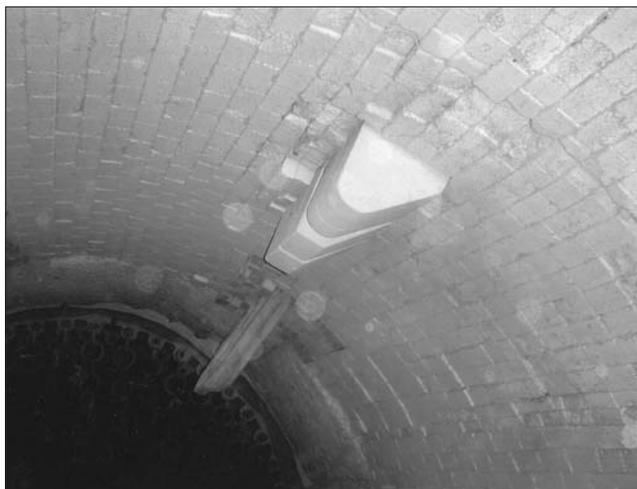
**Рис. 2.** Теплообменные устройства в печи по ходу обжигаемого материала: цепной со свободно висящими цепями; элемент металлического петлевого теплообменника; три элемента полки-лифтера
