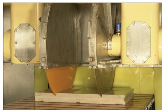
Линия резки оснащена регулируемыми независимо друг от друга пилами. Таким образом, из одного элемента можно производить несколько изделий
