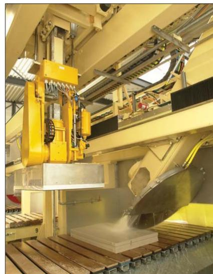
На линии последующей резки возможно производить наклонные резы. Автоматическое устройство съема изделий оснащено вакуумной пластиной, позволяющей поднимать изделия различного формата. Продукция затем упаковывается на деревянных поддонах в соответствии с планируемым способом транспортировки
