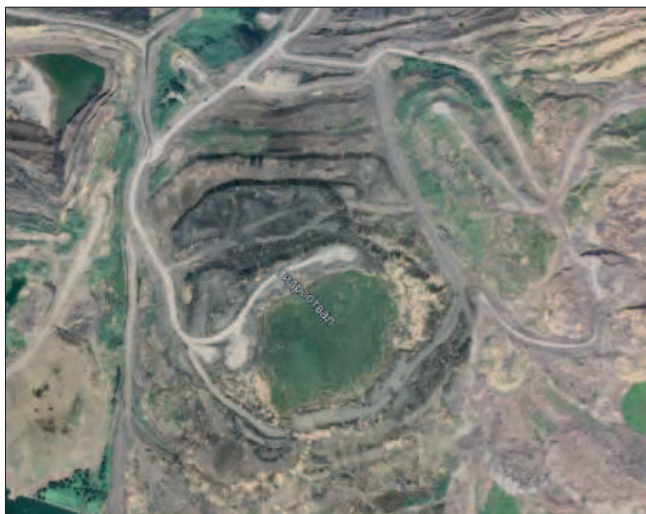
Рис. 3. Гидроотвал Талдинского карьера Fig. 3. Hydraulic dump of the Taldinsky quarry
