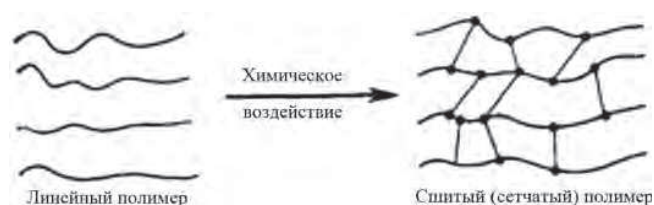
Рис. 1. Схема формирования сетчатого полимера
