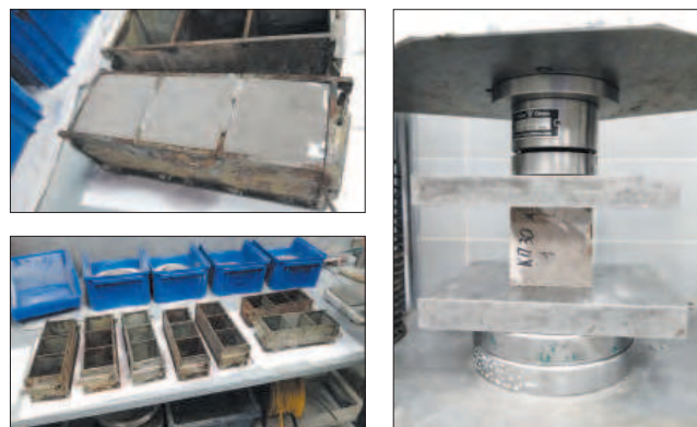
Рис. 8. Формовка образцов-кубов и испытание на контрольный срок Fig. 8. Shaping of sample-cubes and testing for the control period
